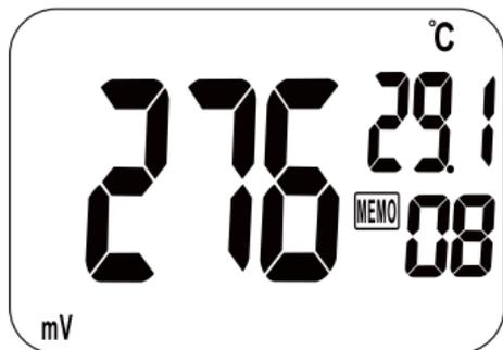
2.将ORP电极放置到待测溶液,轻轻前后左右摆动ORP电极,1分钟左右,待数值稳定即可读数记录数据。
